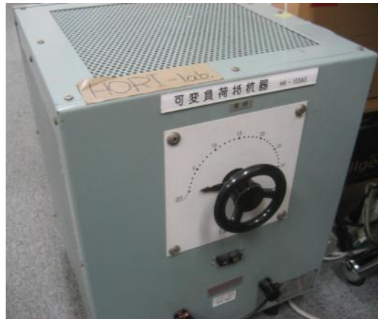
図 5.3 本実験の負荷: 可変抵抗器
