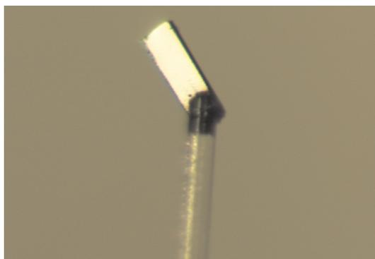
図 2-12 X 線結晶回折用のサンプルの付け方。ガラスロッドにサンプルがアラルダイトで接着してある。
