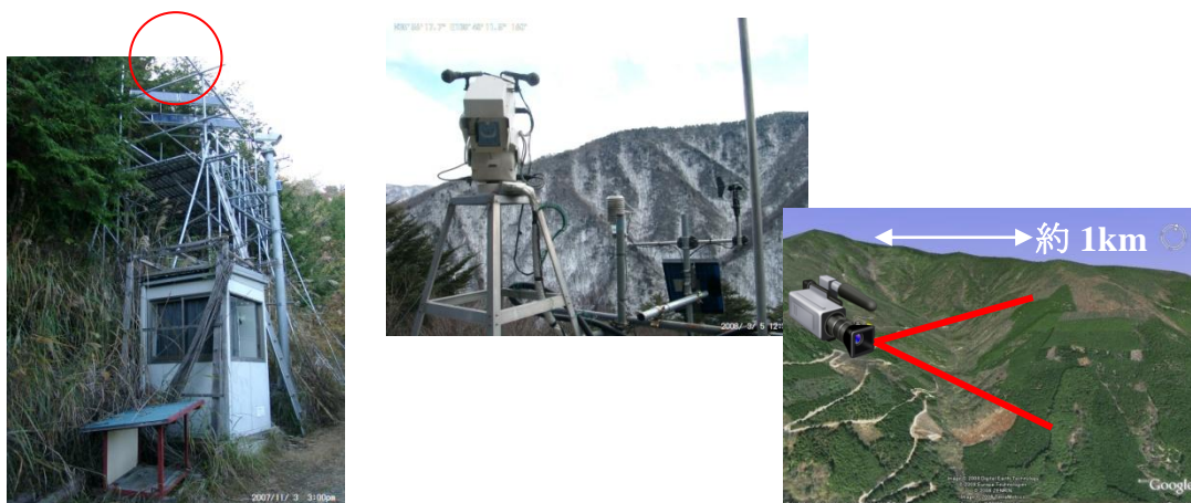
写真1 (左) ロボットカメラ設置の様子 (赤部分にロボットカメラと気象観測装置) 写真2 (中央) ロボットカメラとステレオマイク、気象観測装置の一部 図2 (右) ロボットカメラによる撮影方向
