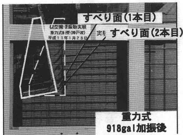
写真 5 重力式擁壁模型の破壊状況 (不規則波加振時) 12)
