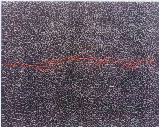
図 12 単相材料におけるメソスケールのき裂進展
