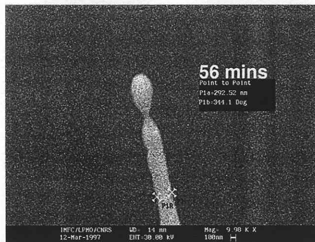
図 1. タングステン探針を真空中で加熱することにより得られる振動子状構造物。
