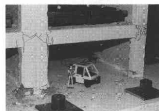
写真：超小型立体試験体を用いた動的耐震実験
