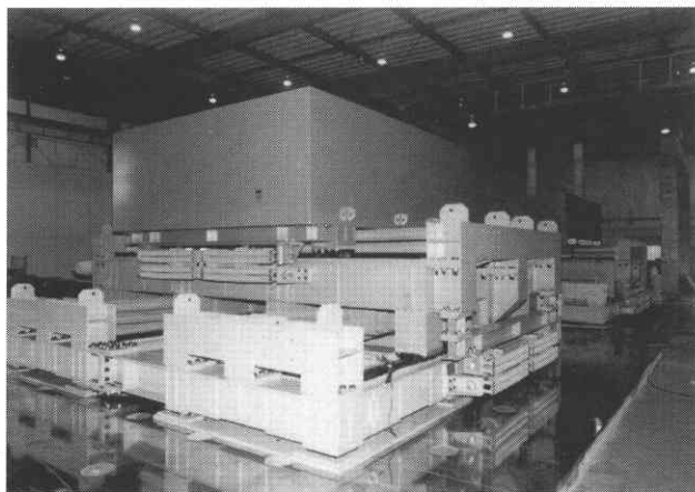
図1 ACサーボモータを用いたアクティブ・パッシブ切換え型マスタダンパの実用例
