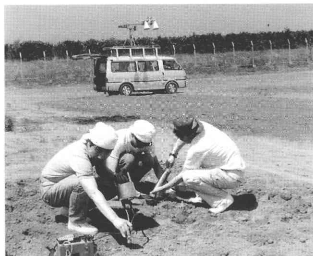
マイクロ波センサーによる土壌水分屋外計測実験
