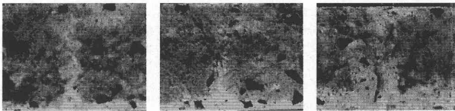
写真-3 ひび割れ部の塩分浸透試験結果 W/C = 70% ひび割れ大 (左: 促進養生期間 1 week, 中: 促進養生期間 4 weeks, 右: 促進養生期間 13 weeks)
