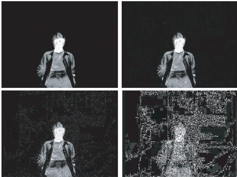
図 3.20: 符号化後のカラー画像から復元した温度画像 (カラー画像の圧縮率 左上:  $\frac{1}{5}$  に圧縮, 右上:  $\frac{1}{10}$  に圧縮, 左下:  $\frac{1}{20}$  に圧縮, 右下:  $\frac{1}{45}$  に圧縮).
