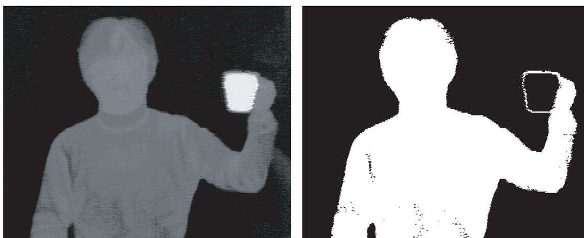
図 3.9: 単純なバンドパスの結果 (左: 入力温度画像, 右: 出力画像).
