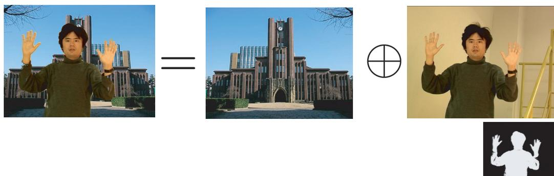
図 4.4: テクスチャ背景 ( $Dst = ImgTex \oplus ImgR_{ImgT}$  の例)
