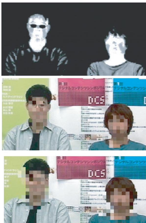
図 5.10: ディレイションの例 (上段：温度, 中段：ディレイション無し, 下段：ディレイション後)。
