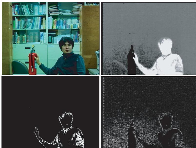
図 3.8: バンドパスによるエッジ抽出 (左上: カラー, 右上: 温度, 左下: バンドパス, 右下: エッジ検出フィルタ (8近傍ラプラシアン)).
