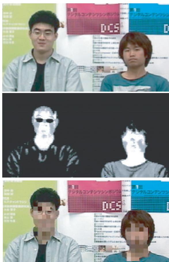
図 5.8: メガネが欠けて顔を覆うモザイクに失敗した例 (上段：カラー，中段：温度，下段：モザイク)。
