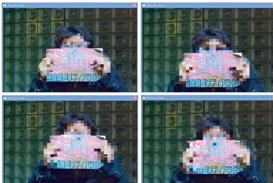
図 5.14: 顔の一部が隠れている場合のディレイションの適用（左上：ディレイション無し，右上：1回ディレイション，左下：2回ディレイション，右下：3回ディレイション）
