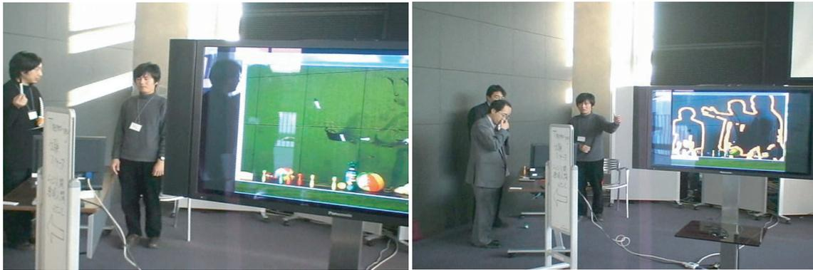
図 4.13: DPA での展示の様子 (左: 透明人間 [人物が透明でペンが見えている様子. ], 右: エッジ人間 [人物のエッジを表示する. 人物が重なっている場合は, 統合された領域のエッジが表示される. ]).
