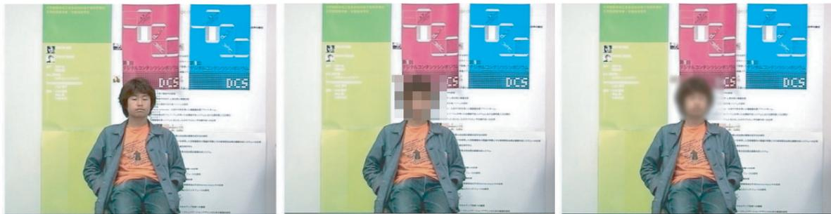
図 5.3: マニュアルで効果を加えたもの（左：原画像 [カラー]，中央：顔の周りを矩形で囲んでモザイク処理，右：顔の周りを矩形で囲んでぼかし処理）
