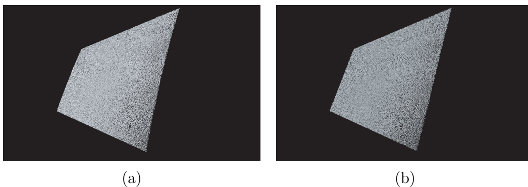
図 5.1: (a) 補正前の平面距離画像 (b) 補正後の平面距離画像
