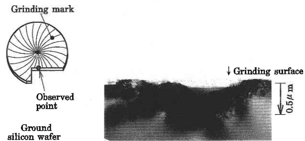
(b) シリコン研削面表層の加工変質層
