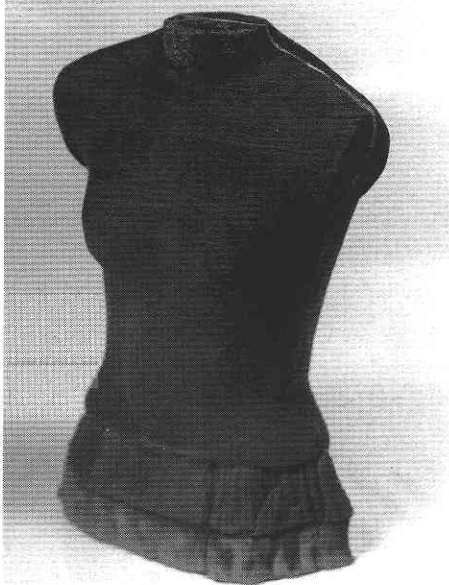
図5 フェノール樹脂含浸による成形体例 (ステンレス粉末：グリーン体)
