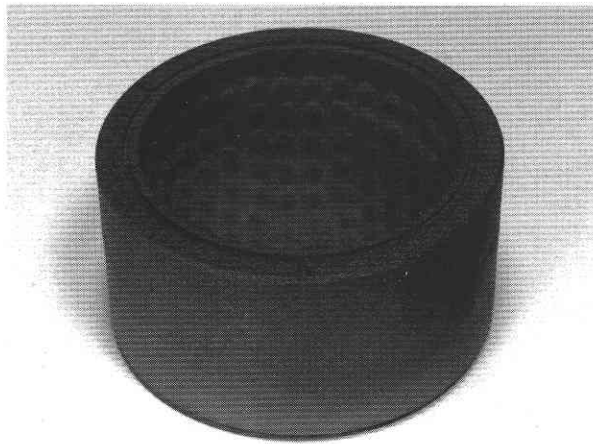
図6 銅溶浸後の金型例 (ハイス粉末：68 vol %，0.4 %収縮)
