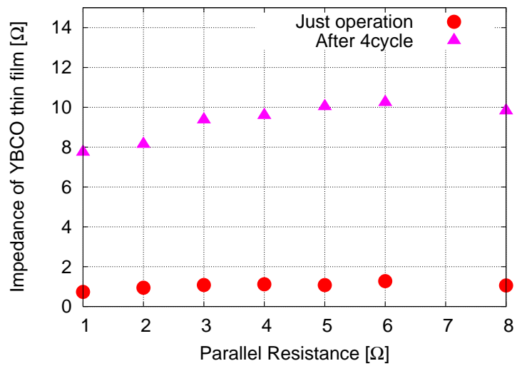
図 4.5: 発生するインピーダンス (並列抵抗を変化)
