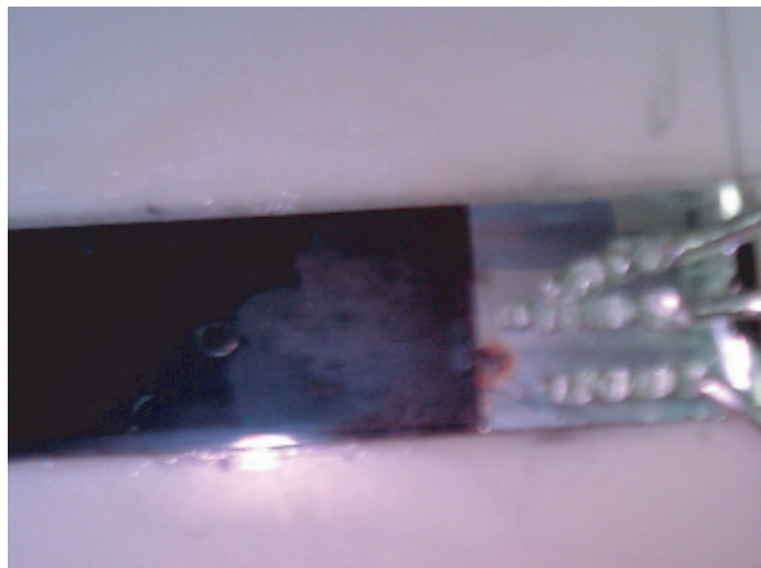
図 3.26: 焼損した薄膜
