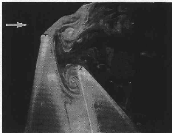
写真4 可視化（風向 180°, TYPE A, 上向き 60° 排気, 左が大塔, 右が小塔）
