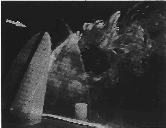
写真1 可視化（風向 90°, TYPE A, 上向き 60° 排気, 手前が小塔, 奥が大塔）
