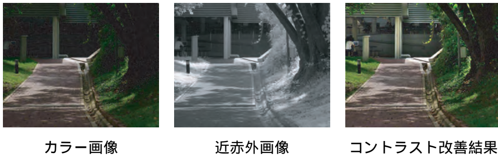
図 2.6: 近赤外画像を用いたコントラスト改善手法の結果
