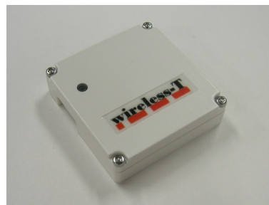
図 4.3: Bluetooth 機能を内蔵した加速度センサモジュール
