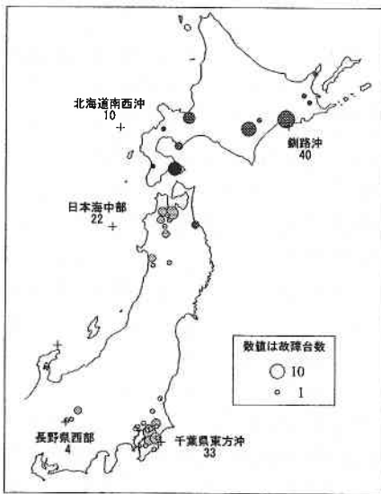
図4 地震によるエレベーターの故障台数 (1993年日本海中部地震以降)
