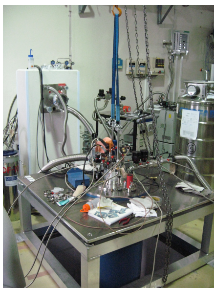
Fig. 3.9 実験で用いた希釈冷凍機
