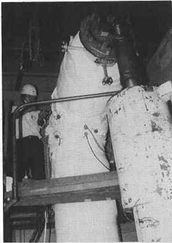
写真 2 開発した第 2 世代 AE 計測システムによる高速増殖炉配管モデル疲労試験 (高温 400°C)
