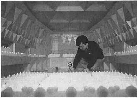
写真4 日立シビックセンターコンサートホールの1/10縮尺模型
