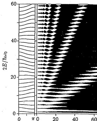
図5 1次元周期を持つ変調磁場下の2次元電子のランダウサブバンド構造(左図)。パラメータの値は  $B_1/B_0 = 0.5$ 、 $d/l_0 = 4$  である。  $2E/\hbar\omega_0 = 7, 20, 40 \dots$  のところでサブバンド分散が極小になっている。右図はエネルギースペクトルを  $(d/l_0)^2$  の関数として表したものの。
