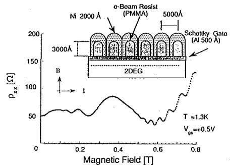
図6 挿入図は、変調磁場による磁気抵抗振動効果を実験的に観測する目的で作製した試料の構造を表している。グラフは磁気抵抗の測定例である。変調構造に関連する振動が観測されているが、これは周期的歪の効果によるワイス振動と解釈される。
