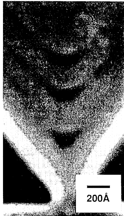
図3 MOCVD選択成長により作製したGaAs量子細線の断面SEM写真(荒川研究室)
