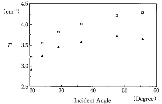
Fig. 3 測定結果。横軸：入射角、縦軸：二光波混合結合係数。四角い点は相互作用長変化法による測定値。三角は従来法による測定値。
