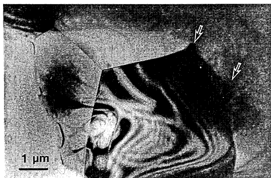
図1 AlN常圧焼結体の透過電顕像
