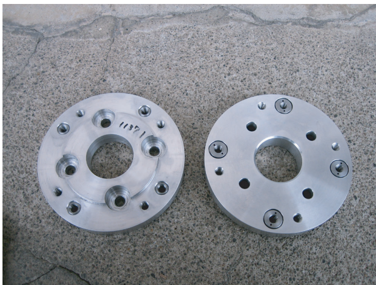
Fig. A.9: PCD チェンジャー概観図
