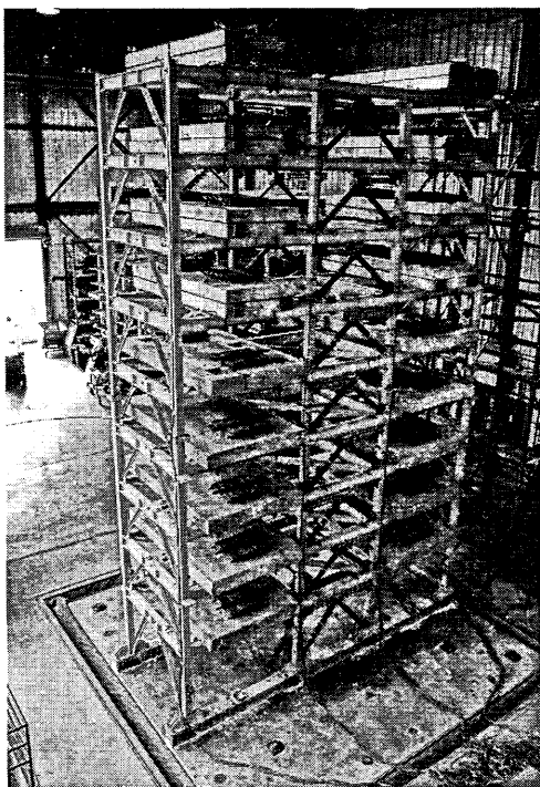
図4 摩擦ダンパを用いた建物モデルの振動実験
