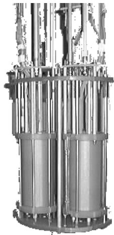
図 3.4: 三相交流用超電導限流器のコイル部分
