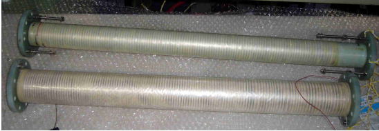
図 3.7: 銀シース BSCCO 線材を用いて試作された変圧器型限流器
