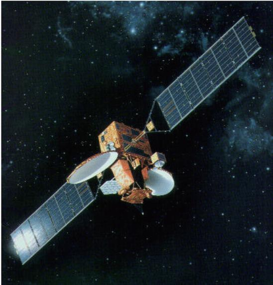
図 1.1: 柔軟衛星の安定化制御を行った衛星の一例: 技術試験衛星 VI 型の概観
