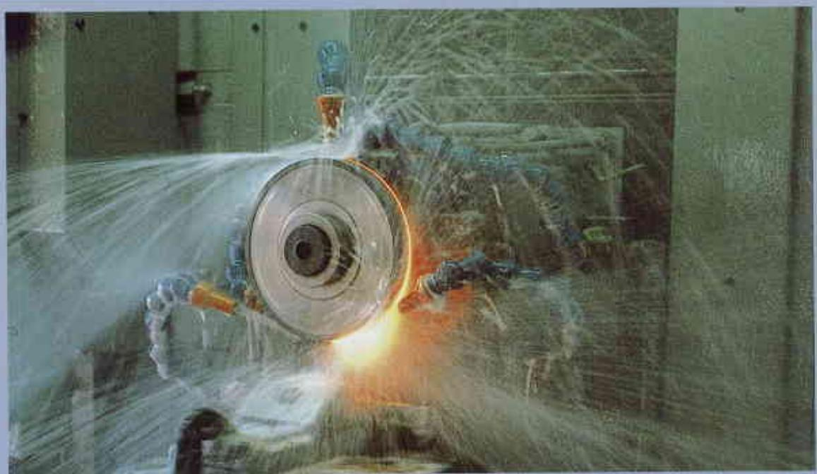
鉄鋳ファイバボンド砥石による $\text{Si}_3\text{N}_4$ のマシニングセンタによる高能率研削
