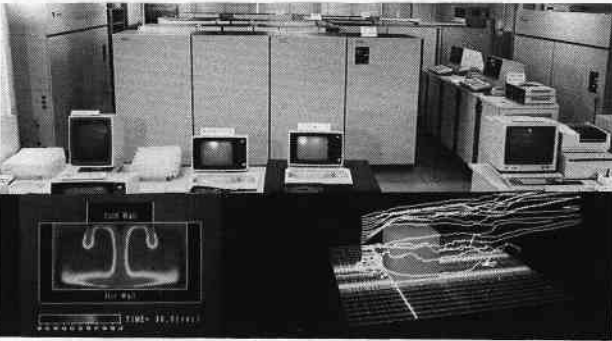
電子計算機室 電算機の利用は年々増加しつつある。昭和54年より2回機器更新し、現在の主システムは昭和60年9月に設置されたFACOM-380 Qと昭和61年12月に新たに導入されたスーパーコンピュータFACOM VP-100である。
