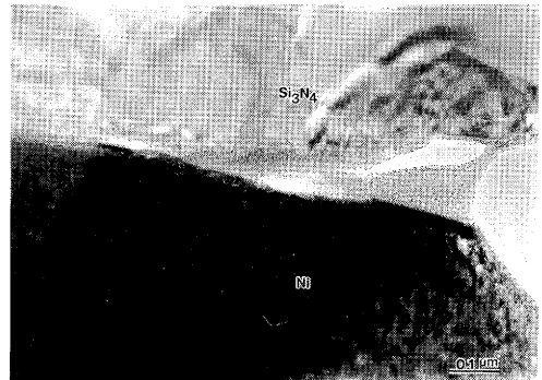
Fig. 4 非晶質相を含む窒化ケイ素とニッケルの界面組織
