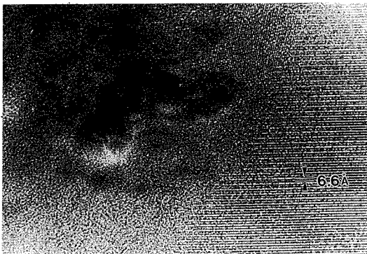
写真4 窒化ケイ素表面層の微細粒子の高分解能像
