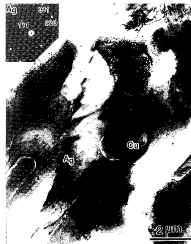
写真2 ロウ材部分の微細組織
