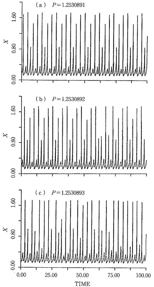
図 5  $P=1.2530891$  (a),  $1.2530892$  (b),  $1.2530893$  (c) における振動挙動。(b), (c) において  $\pi(2)$  と  $\pi(1)$  が混合した間欠性カオス振動が現れている
