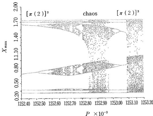
図 3 二つの3周期振動の間の分岐構造
