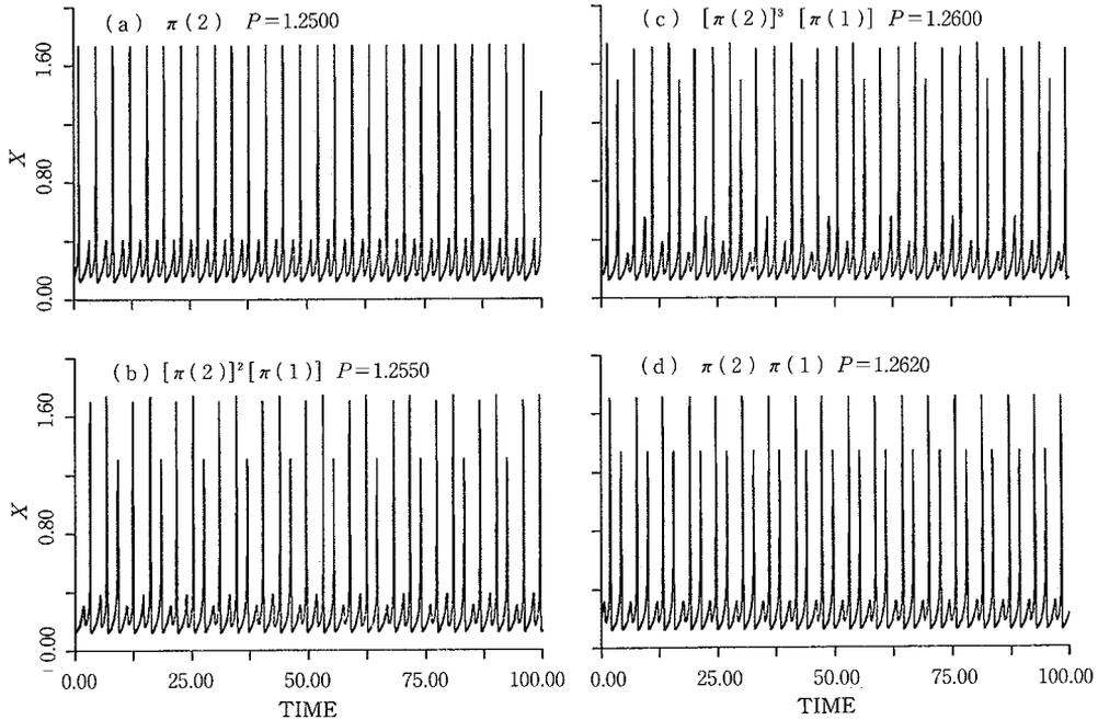
図 2  $\pi(2)$ と $\pi(2)\pi(1)$ の間の結合複合振動
