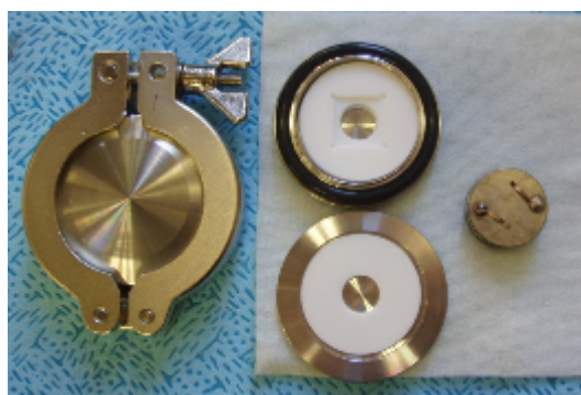
Fig. 2-9 サンプル搬送に用いた密閉ケース(左)を開いた状態(中), および XPS 用サンプルホルダ(右)
