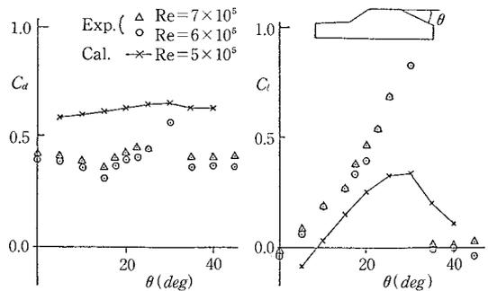
図 6 後部傾斜角による揚抗力の変化
