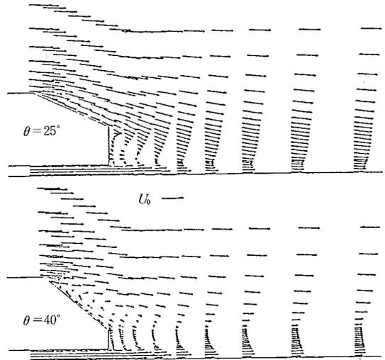
図 5 自動車後部対称線での速度ベクトル
