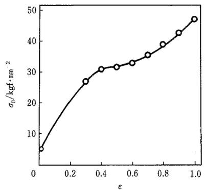
図4 りん脱酸銅の加工硬化曲線
