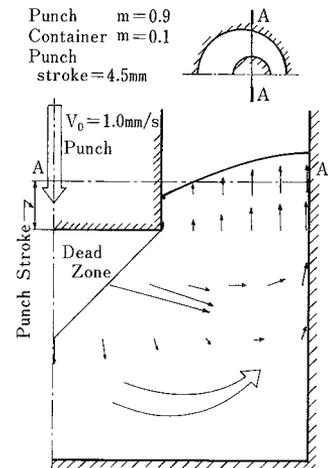
図9 軸を含む縦断面での速度分布
