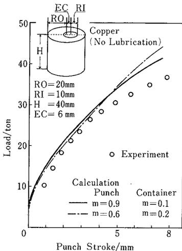
図7 荷重-ストローク線図
