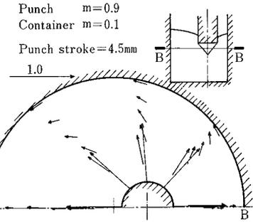
図10 軸に垂直な断面での速度分布
