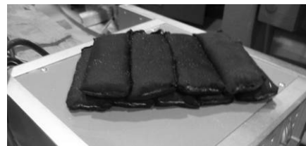
写真-1 投入したサンドチューブを用いた潜堤の写真
