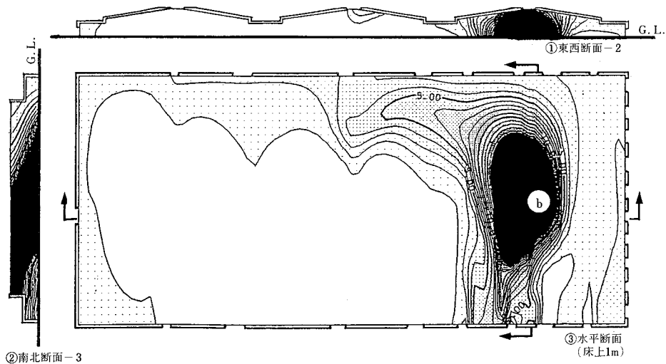
図7 南風の汚染質拡散性状 (汚染質発生 b 点)
