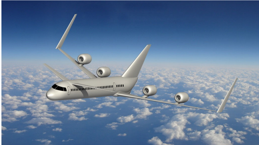
図 6 電動ハイブリッド推進航空機の例(文献 23)より引用)
