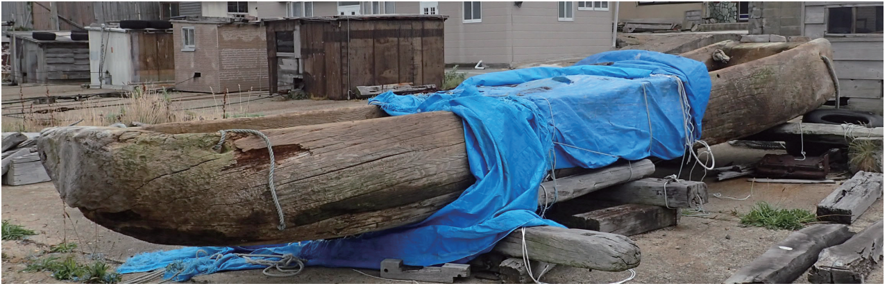
写真7 男鹿・戸賀漁港に係留された丸木舟（1） 岩礁漁のため全体が厚手・頑丈に作られていることがわかる（2018年佐藤撮影、第2図Bと同じ）
