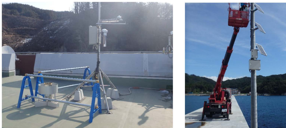
図2 (左) 旧国際沿岸海洋研究センター屋上に仮設置された気象計(気温・湿度・海面気圧・日射・放射・雨量等)。(右) 蓬莱島近くの突堤上で復旧を果たした風速計。
