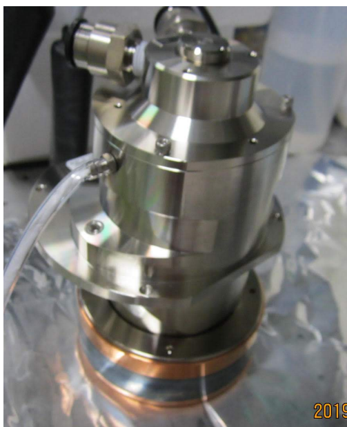
図 4.2: 熱電子を照射する銅のターゲット。最下部の茶色い部分に銅が蒸着されており、ここに熱電子を照射する。
