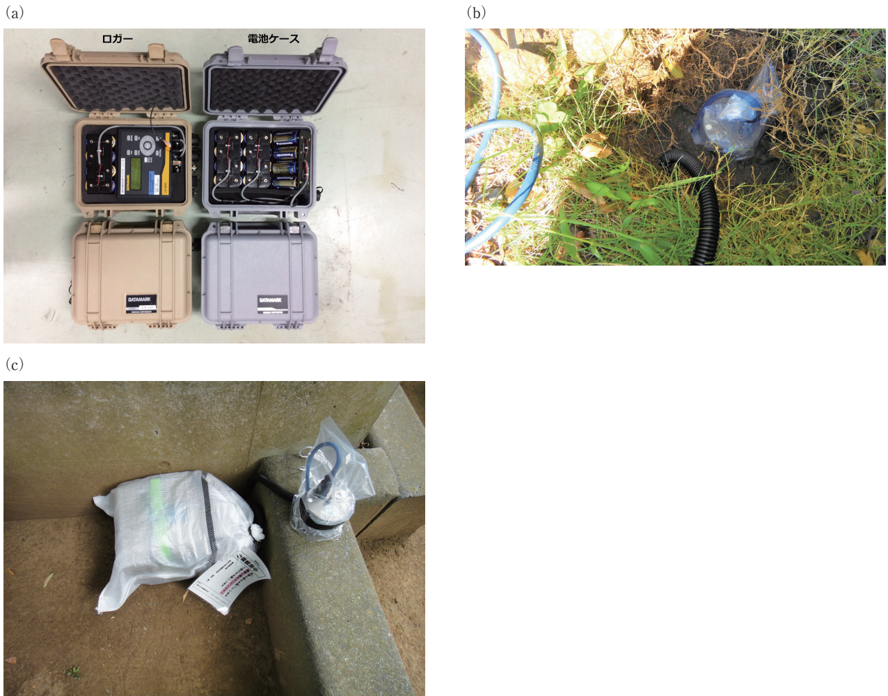
図 2. 石瀬ほか(2020)の臨時地震観測で使用された観測機器と地震計設置例. (a) ロガーと電池ケース. (b) 埋設設置の例 (E.SKRI). (c) 地表設置の例 (E.INZ4).
