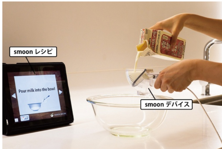
図 7.6: smoon システムの外観。レシピと連動して計量カップの容量が自動で変化する
