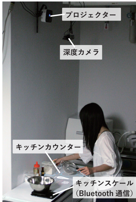
図 7.2: Shadow Cooking のシステム構成. 深度カメラでユーザの動作や物体の位置を認識し, プロジェクターで直接キッチンカウンターに指示を表示する. キッチンスケールと連動することで計量ミスを防止する.
