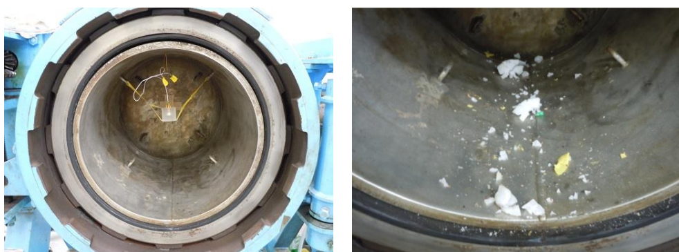
(a) 試験前のチャンバ内・中心が供試体 (b) 試験後のチャンバ内・破碎された供試体
