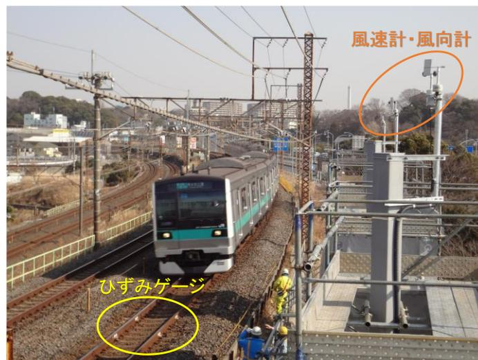
図 4.5 営業路線における輪重・風向風速測定試験の様子
