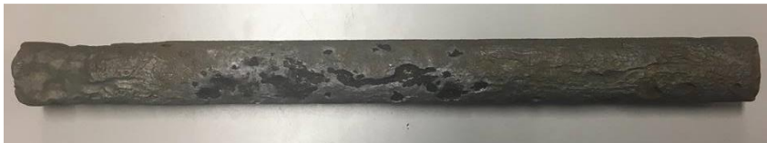
(d) 4 weeks corroded round bar (12.1% corrosion)
