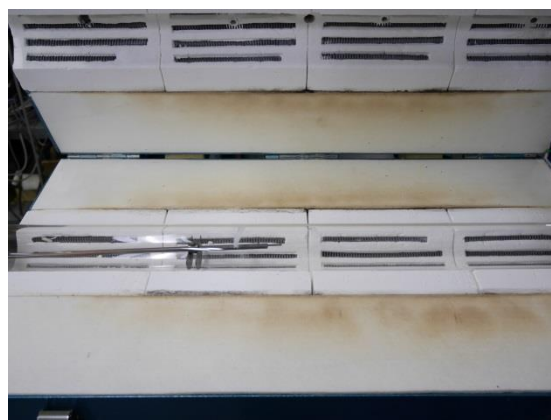
写真 4.1.2 チューブ炉試験装置加熱炉内
