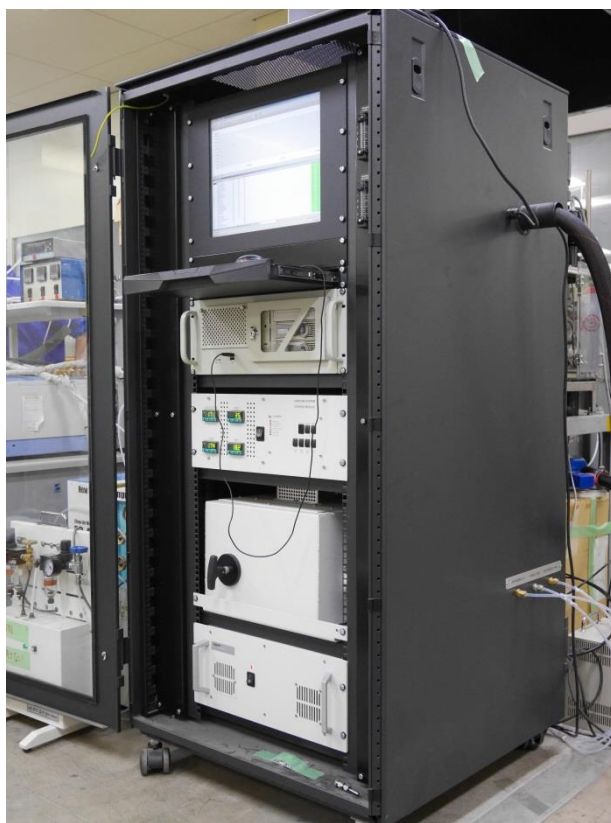
写真 3.2.3 フーリエ変換赤外分光連続ガス分析装置(FTIR)
